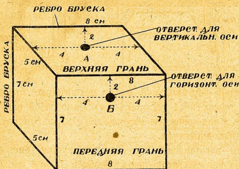
Рис. 47. Подшипник (размеры в см).
